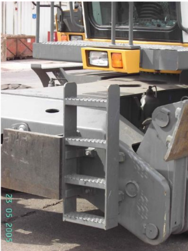
Bagger mit neuem Aufstieg
