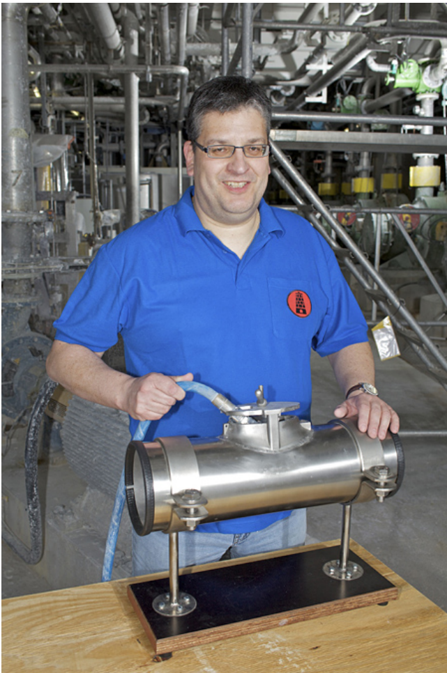
Torsten Hoffmanns Erfindung verhindert, dass Mitarbeiter beim Reinigen von Rohrleitungen von einem Hochdruckwasserstrahl getroffen werden. Foto: BG RCI/Plöger
