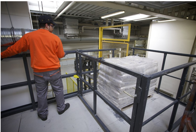
Schiebetor wird geschlossen - erst dann kann die Zugangstür geöffnet werden
