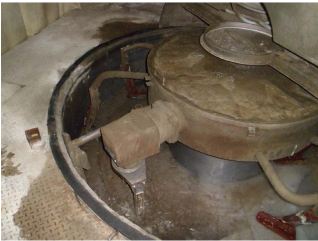
Geöffneter Mischer mit sichtbaren Mischarmern
