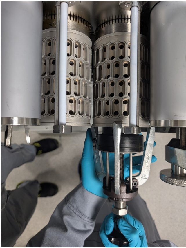
Ansetzen des Abziehers
