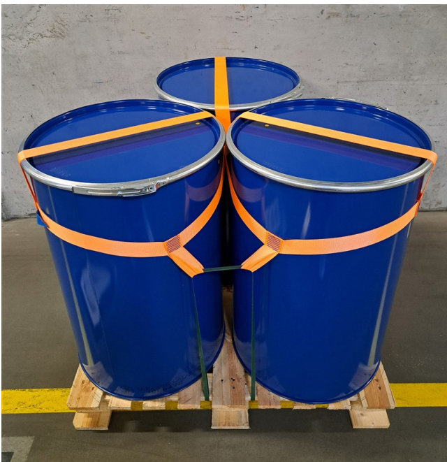
Neue Zertifizierte wiederverwendbare Methode – Beispiel drei Fässer
